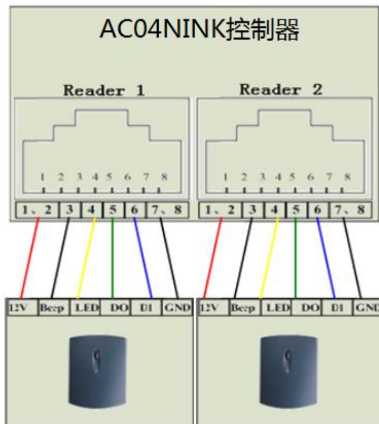
图 4-10 读卡器接线图
