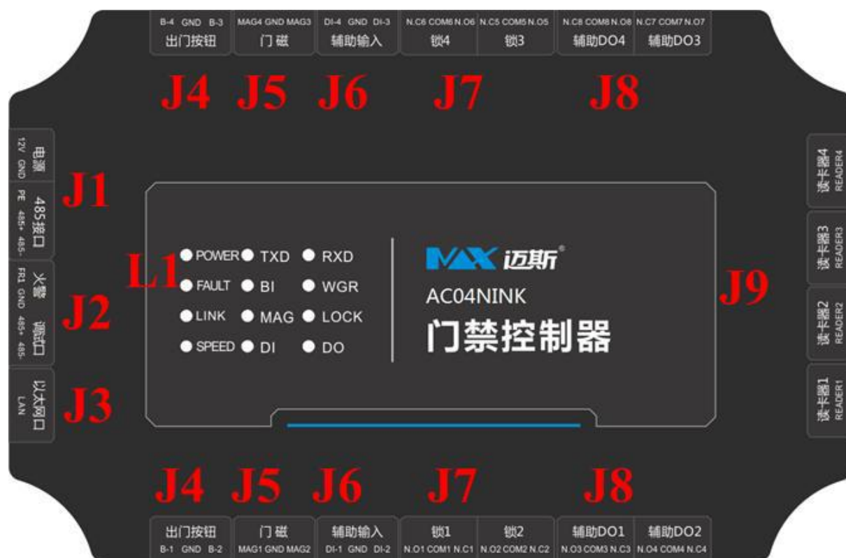
图 4-1 MAX-AC04NINK 接线端口图
