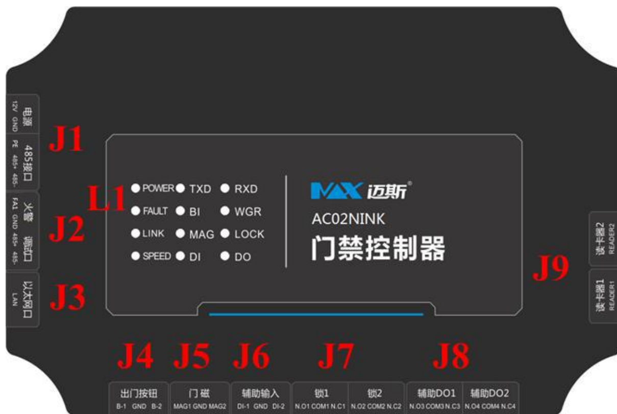
图 4-2 MAX-AC02NINK 接线端口图
